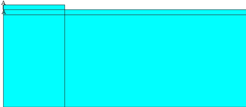
图 3.4-1 1 层 1 米的浇筑块模型
